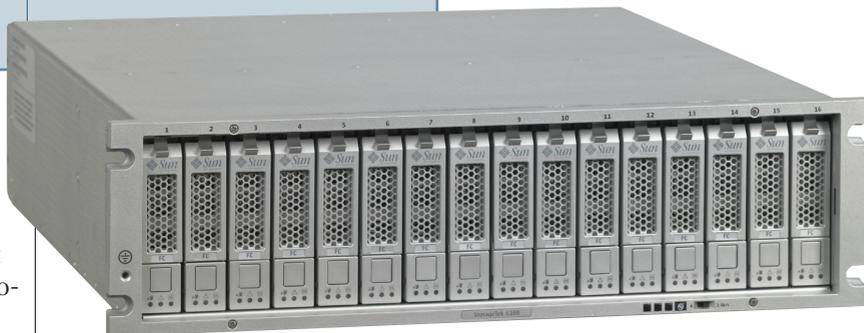
Основной и резервный дисковые массивы Sun StorageTek 6140 предусматривают расширение до 112 дисков общим объемом 112 ТБ
