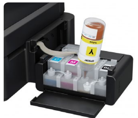
Блоковый блок с четырьмя контейнерами чернил по 70 мл, из которых чернила поступают в печатающую головку
