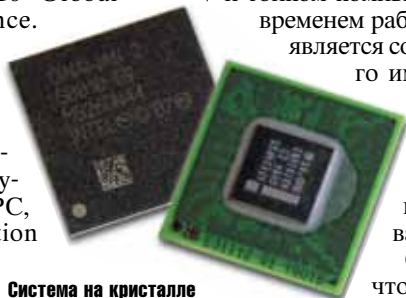
Система на кристалле Intel Z6xx (слева) и Platform Controller Hub MP20 (справа)
