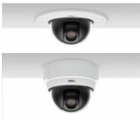
Сетевые PTZ-камеры не имеют возможности полного непрерывного панорамирования с углом 360 градусов из-за механического ограничителя. Исключение составляют камеры с функцией поворота Auto-flip, например, AXIS 215.
