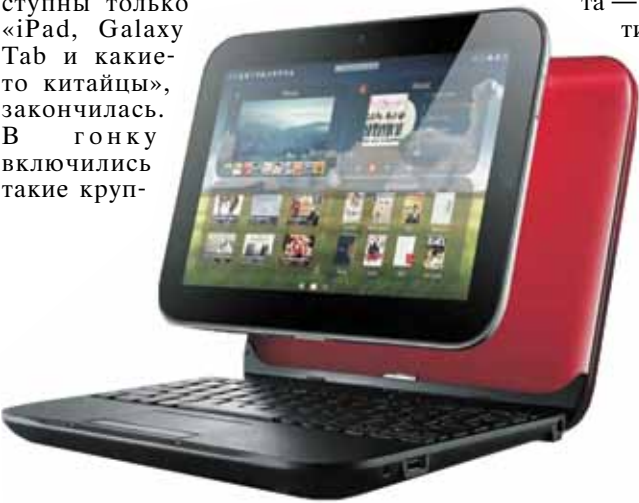
Еще один вариант док-станции. По внешнему виду он напоминает нетбук, только без материнской платы и жесткого диска — лишь клавиатура и порты
