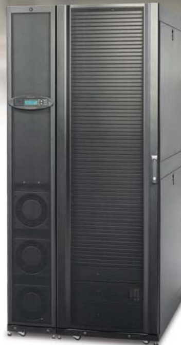
Блок кондиціонування рядного типу APC InRow забирає гаряче повітря безпосередньо з тильного боку серверних шаф, подаючи охолоджене повітря з фронтального боку шаф з IT-обладнанням.
