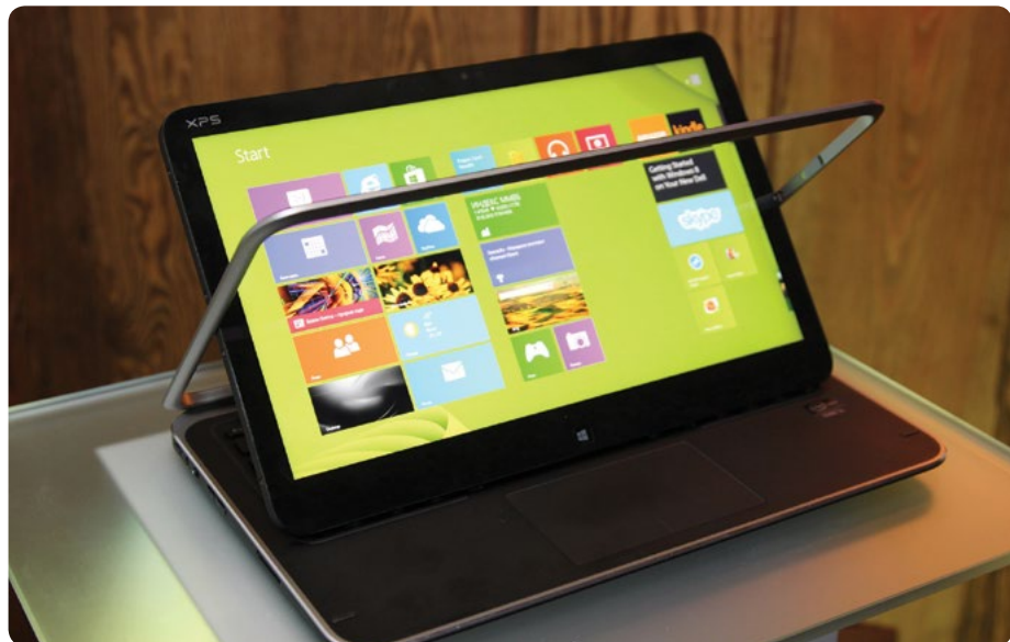
Необычность устройства Dell XPS 12 заключается в том, что дисплей ультрабука может вращаться внутри рамки верхней крышки, превращая его таким образом в планшет
