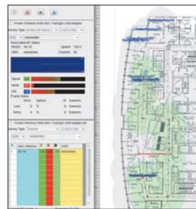
С помощью версии 8.0 я мог проводить активные и пассивные исследования одновременно. На иллюстрации показан тот этап исследования, когда я обходил здание, собирая информацию о сигналах Wi-Fi
