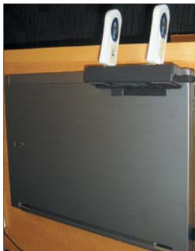
AirMagnet поддерживает два адаптера, которые Survey Pro 8.0 использует в качестве сенсоров. AirMagnet продает набор из двух адаптеров сети 802.11a/b/g/n и концентратора USB за 345 долл
