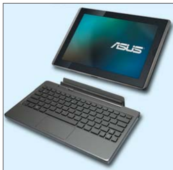
Планшет ASUS Eee Pad Transformer оснащён 10,1-дюймовым емкостным сенсорным дисплеем и построен на процессоре Nvidia Tegra 2
