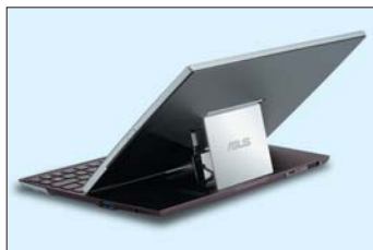
Главная особенность 10,1-дюймового ASUS Eee Pad Slider с сенсорным дисплеем на матрице IPS — выдвижная QWERTY-клавиатура
